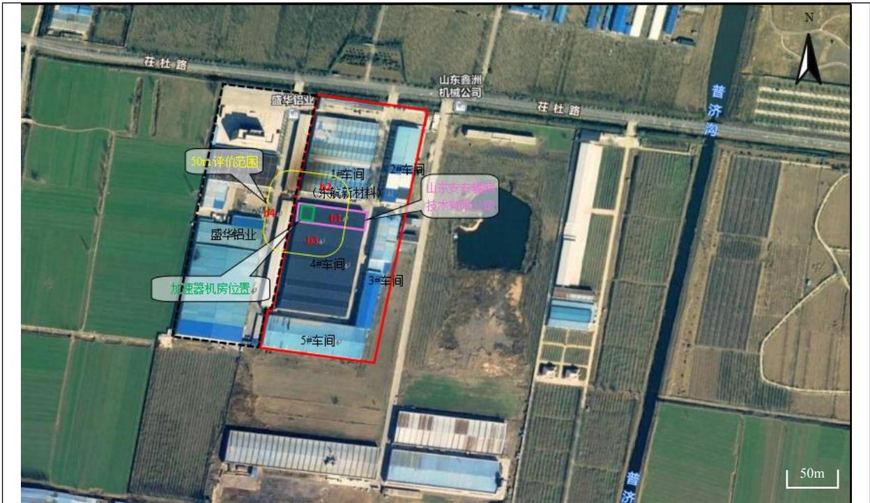
图 6-3 加速器周边敏感目标处 $\gamma$ 监测布点图
