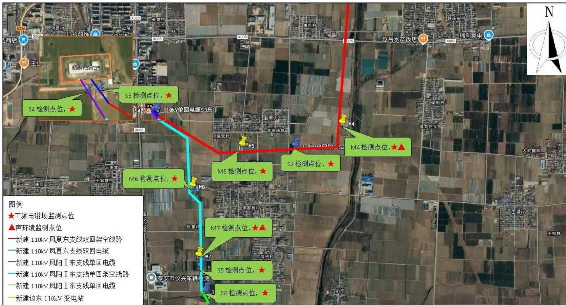
图 7-3 本项目送电工程总体监测布点示意图
